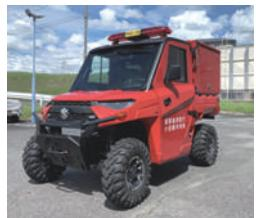
この車両は急傾斜地などの不整地走行に優れた四輪駆動車で、ぬかるみではクローラー（キャタピラー）を装着して踏破性を高められます。通常の消防車両では進入困難な地域での救助活動や、土砂災害現場での資機材搬送などに効果を発揮します。神奈川県内での同車両配備は初めてで、今後は市内の災害対応だけでなく、要請を受ければ緊急消防援助隊として県内外にも出動します。
